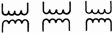
Groupe de transformation composé de trois unités monophasées.
